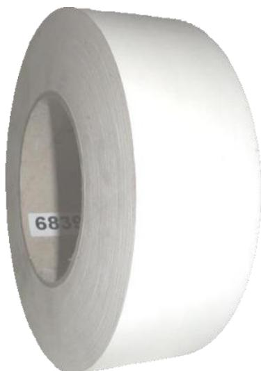
Glasgewebeklebebänder sind sehr reißfest und im Hochtemperaturbereich beständig, in Verbindung mit verschiedenen Kleberausführungen wärmehärtend. Glasgewebeklebebänder mit Alubeschichtung werden u.a. zur Reflektion von Strahlungshitze eingesetzt. Die Oberflächen sollen sauber und trocken sein, lose Teile, sowie Staub ist möglichst zu entfernen. Die Lagertemperatur soll nicht unter 10°C liegen, die günstigste Verarbeitungstemperatur liegt bei 15 - 40°C.
