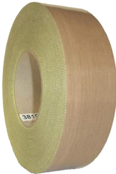
Teflon\*-Glasgewebe-Filmklebebänder haben hervorragende Eigenschaften, temperaturbeständig -75 bis +260°C, chemische Beständigkeit, beständig gegen mechanische Einwirkung, hohe dielektrische Eigenschaften, formbeständig, geringer Reibungswiderstand, Antihafteigenschaften, durch die glatte Oberfläche als Trennfilm bei Heißversiegelung und Laminatprozess, oder Arbeiten mit Lack-Kleberharzen und Nahrungsmittel, in der Verpackungsindustrie und Folienschweißeinrichtungen geeignet.
