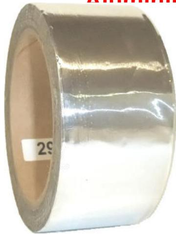
Aluminiumklebebänder sind hervorragend form- und anpassungsfähig, wasser- und dampfdiffusionsdicht. Aluminiumklebebänder werden mit oder ohne Linertrennlage geliefert. Die Oberflächen sollen sauber und trocken sein, lose Teile, sowie Staub ist möglichst zu entfernen. Die Lagertemperatur soll nicht unter 10°C liegen, die günstigste Verarbeitungstemperatur liegt bei 15 – 40°C.
