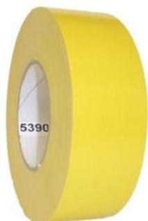
Gewebeklebebänder sind stark klebend und Form anpassungsfähig. Der starke Kleber ist nicht korrosiv ausgerüstet und gut UV-beständig. Spezielle Typen lassen sich rückstandsfrei von der Oberfläche entfernen. Die Gewebeklebebänder sind PE-beschichtet ggf. PVC und dadurch wasserfest und beschriftbar. Die sehr große Farbpalette ist lieferbar mit einer glänzenden und einer matten Oberfläche.
