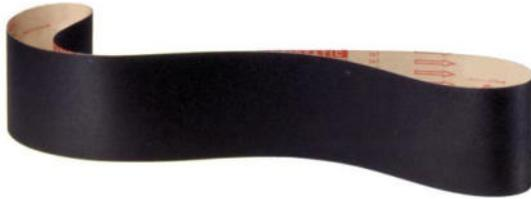
Im Bereich Innenausbau/Bauelementfertigung wird zum Kalibrieren von Massivholz, Sperrholz u.ä. ein offen gestreutes (1) Schleifband auf starker F-Papierunterlage eingesetzt, mit staubabweisender (3) Beschichtung.
